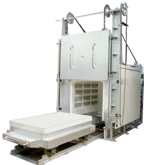
本台車炉は、主に重量物の熱処理を対象とし、処理物の出し入れが容易で安全性を高め、作業性が優れています。また、気密性がよく3ゾーン制御で温度分布も優れています。
