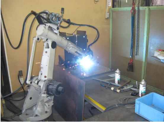
プログラム入力することによりロボットが自動で溶接する方法です。
