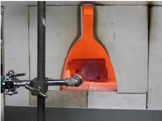
ロウ付けとは、部品と部品の間に熔解した「ロウ」を流し込み、部品と部品を固定する方法です。部品を溶かすことなく接合できます
