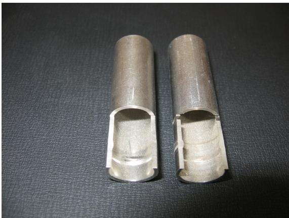
自動溶接機による高信頼性の溶接による裏波ビードが得られます。
